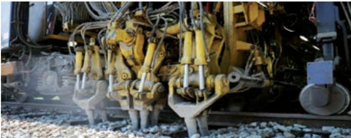
Wie jede Infrastruktur brauchen auch Bahnstrecken Service, damit Züge sicher und pünktlich unterwegs sind. Das Schotterbett stabilisiert die Gleise in der optimalen Lage und wird deshalb regelmäßig von einem maschinellen Durcharbeitszug bearbeitet.
